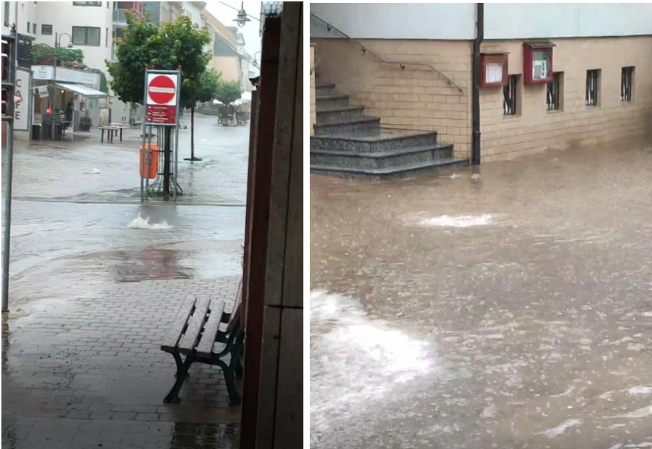
Abb. 4-62: Überlastetes Kanalsystem St. Goar bei Starkregen
