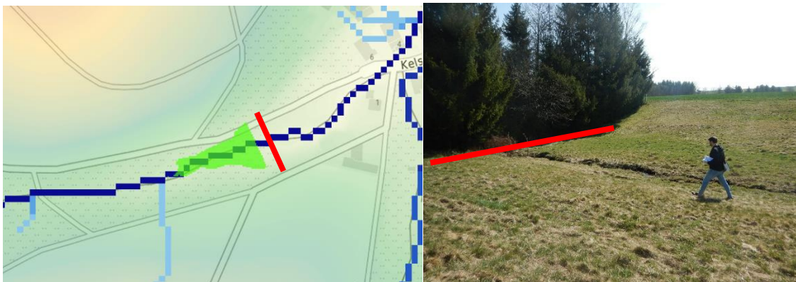
Abb. 4-37: Möglicher Retentionsraum bei einem Einstau auf 412 m NHN.
