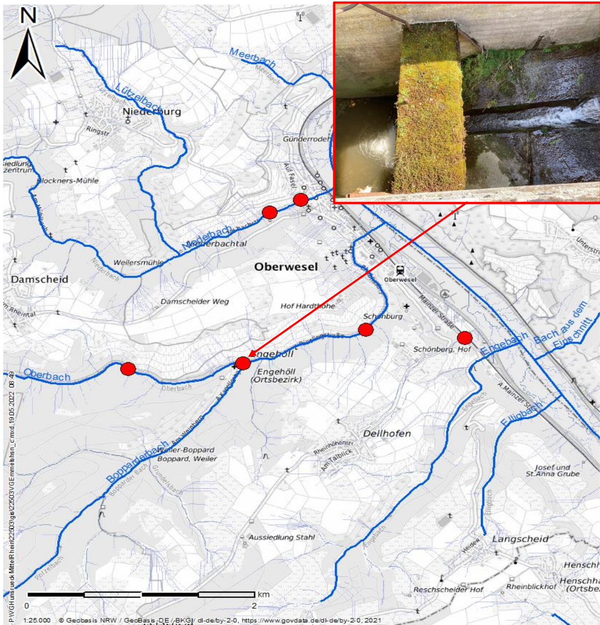
Abb. 4-86: Querbalken in Einlaufbauwerk des Bopparder Baches im Stadtteil Engehöll
